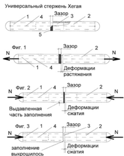
Устройство для визуального наблюдения за поведением трещин в зданиях и сооружениях
